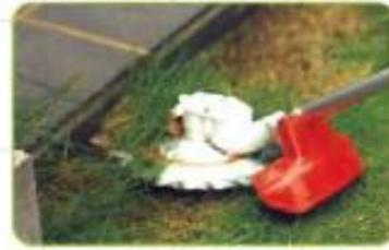
**Principe:** Le système de lame réciproque évite les projections et le recul au contact des obstacles.
